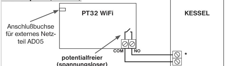
\* Die Klemmen für das Thermostat sind bei jedem Kesseltyp verschieden bezeichnet, deshalb halten Sie die vom Kesselhersteller vorgegebenen Richtlinien ein! (Achtung: Das Thermostat kann nicht bei 2poligen BUS-Leitungen verwendet werden!)
